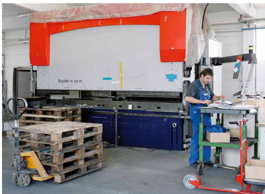
Seit April 2006 erledigt eine Abkantpresse der Beyeler PR-Serie (und damit gleichfalls ein Produkt aus der Bystronic-Gruppe) die immer öfter geforderten Anarbeitungen im Bereich des Biegens.
